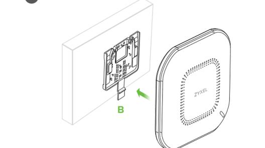
**CZ** **2** Skrze otvory v rámu (B) provlékněte dva šrouby a ty vsadte do hmoždinek; tím zajistíte rám na zeď/strop. Zkontrolujte, zda jsou šrouby pevně a bezpečně upevněny do zdi/stropu.
