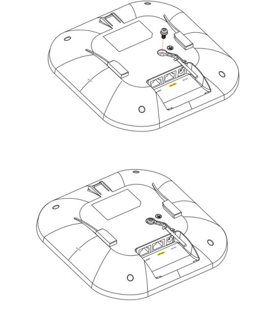
**SE** **1** Skruva bort M4 jordskruven från WAX510D bakpanel enligt bilden. Säkra en grön/gul jordkabel (18 AWG eller mindre) till WAX510D bakpanel genom att använda M4-jordskruven.
