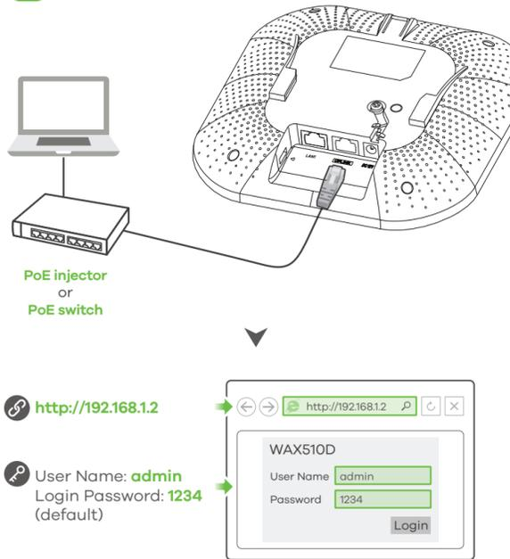
**CZ** **1-b** Pomocí ethernetového kabelu připojte počítač k portu **UPLINK** zařízení WAX510D přes injektor nebo přepínač PoE. Pro přístup k webovému konfiguratoru použijte IP adresu zařízení přiřazenou přes DHCP nebo výchozí statickou IP adresu „http://192.168.1.2“. IP adresa počítače musí být ve stejné podsíti jako IP adresa zařízení WAX510D.
