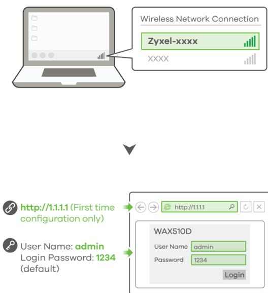
**SE** **1-a** Från en WiFi-aktiverad dator söker du efter WAX510D:s standard-WiFi nätverksnamn (**ZyXel-xxxx**, där xxxx är de fyra sista tecknen i MAC-adressen) och ansluter till den.
