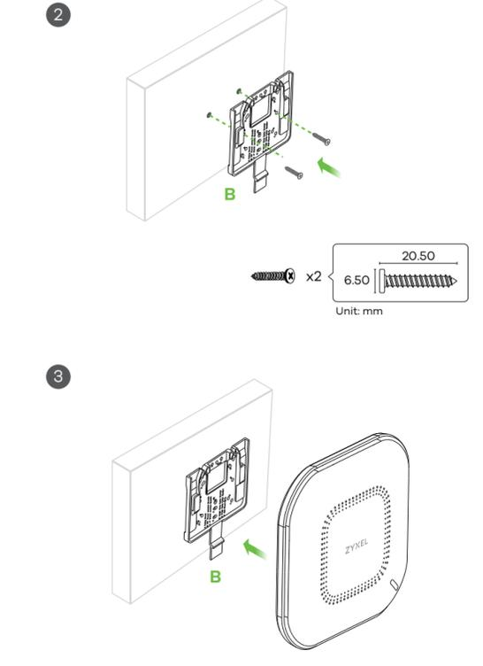
**SE** **2** Installera de två monteringskruvarna i hålen i fästet (B) i pluggarna/förankringarna för att säkra fästet i väggen/taket. Se till att skruvarna ligger tätt och säkert mot väggen/taket.
