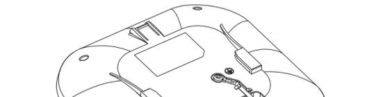
**CZ** **1** Podle obrázku vyjměte uzemňovací šroub M4 ze zadního panelu zařízení WAX510D. Připevněte zelenožlutý uzemňovací kabel (18 AWG nebo menší) k zadnímu panelu zařízení WAX510D pomocí uzemňovacího šroubu M4. **2** Druhý konec zemního kabelu připevněte na zeď nebo na zem. Postupujte podle předpisů vaší země a bezpečnostních pokynů pro řádné uzemnění elektrických zařízení. Funkčnost ochranného uzemňovacího terminálu budovy musí potvrdit kvalifikovaný pracovník servisu.
