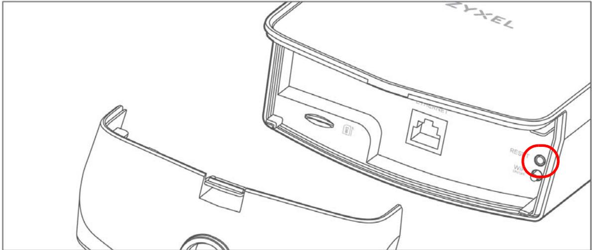
**Figure 14** Reset Button (LTE7461-M602 / LTE7480-M804 / LTE7480-S905 / LTE7490-M904)
