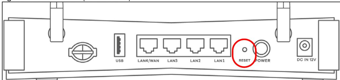
**Figure 13** Reset Button (LTE7240-M403)
