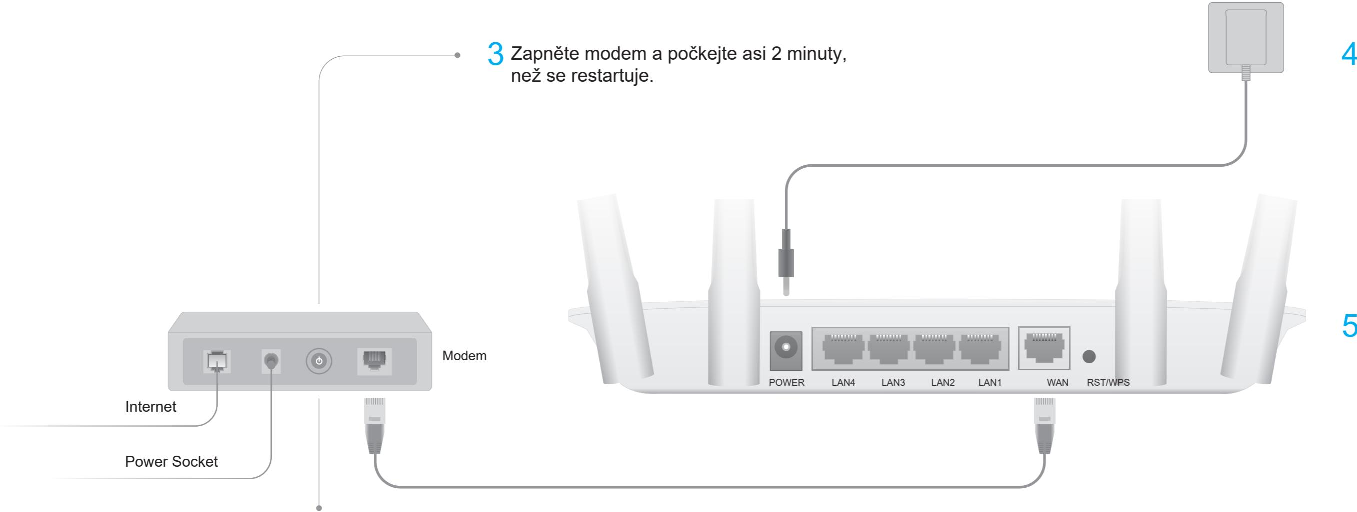
**2** Připojte port WAN routeru k DSL/kabelu Modem/Ethernet.
