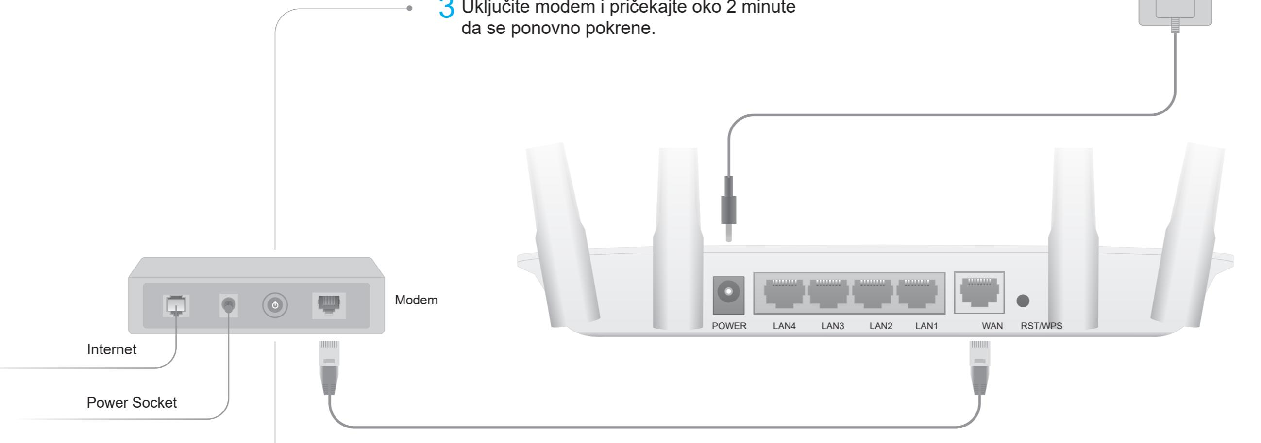
**4** Priklučite strujni adapter na usmjerivač.
