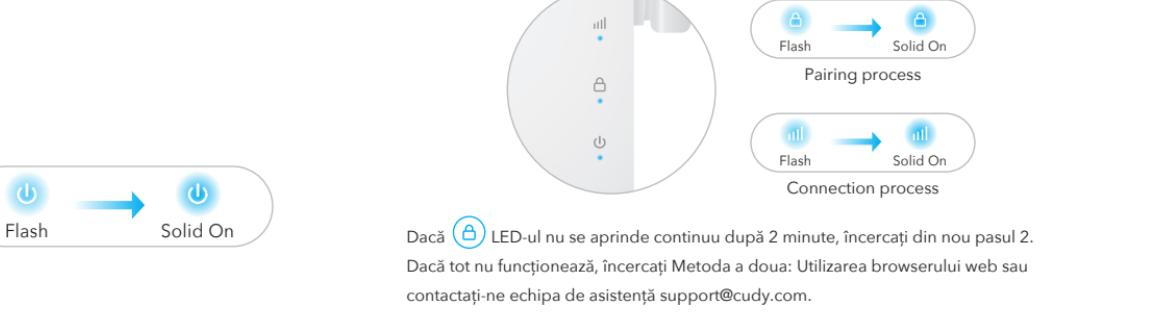
2. Apăsați butonul WPS de pe router, apoi apăsați pe WPS butonul de pe extender în 2 minute.
